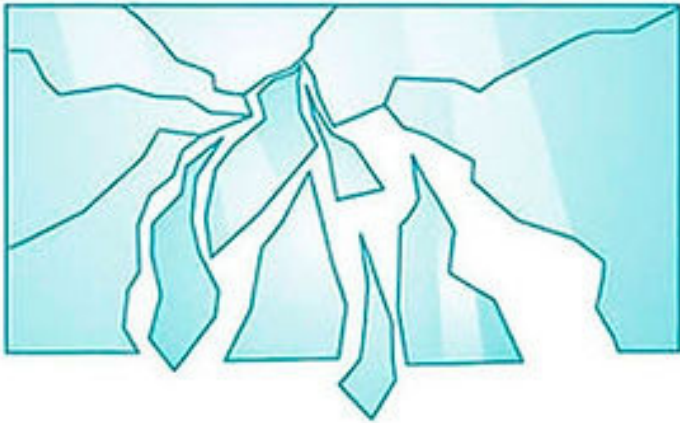
Rotura de Vidrio Normal
